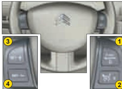
Ce système permet de choisir une vitesse maximale à ne pas dépasser.
