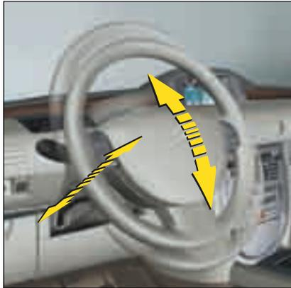
À l'arrêt, déverrouillez le volant en poussant la commande vers l'avant.
