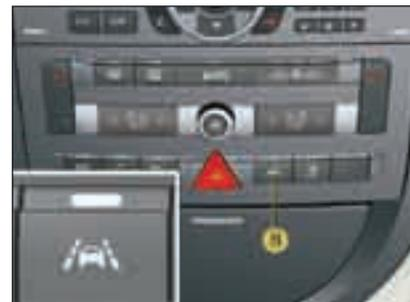
Ce dispositif d’aide à la conduite vous alerte d’un franchissement involontaire du marquage longitudinal au sol (ligne continue ou discontinue). Il est destiné à un usage sur les autoroutes et voies rapides, et fonctionne uniquement **au-delà d’une vitesse d’environ 80 km/h**.
