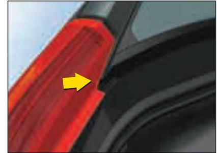
5. Remplacez le bloc optique en insérant en premier le pion le plus en avant puis poussez. Assurez-vous de repositionner les joints de la lunette arrière et des feux dans leur position initiale.
