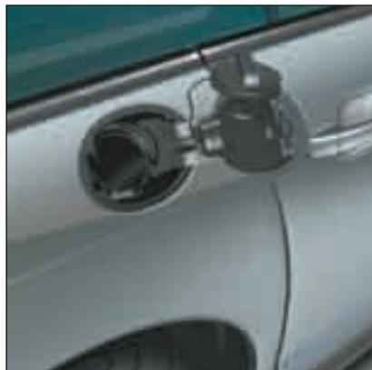
Pour ouvrir la trappe, appuyez sur la commande **A**. Dévissez le bouchon et accrochez-le à la patte située sur la face intérieure de la trappe.
