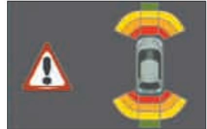
Des capteurs de proximité sont situés dans les **pare-chocs avant et arrière** de votre véhicule.
