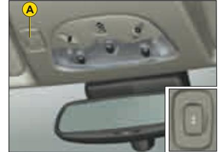
La commande électrique **A** permet d'actionner le toit ouvrant
