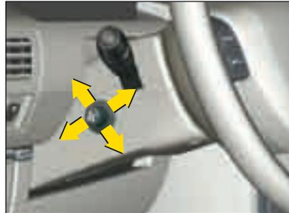
À l'arrêt, ajustez la hauteur ou la profondeur du volant en déplaçant la commande :
