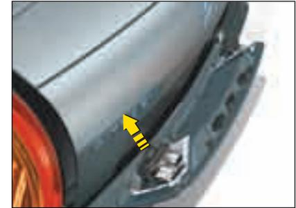
Déclipez avec un outil les porte-lampes pour les retirer et les changer.
