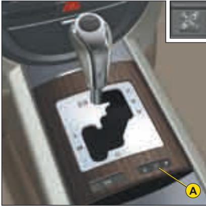
La suspension active à flexibilité et amortissement pilotés règle automatiquement et instantanément les amortisseurs en fonction de votre style de conduite et de l'état de la route pour concilier au mieux votre confort, celui des passagers et obtenir la meilleure tenue de route.
